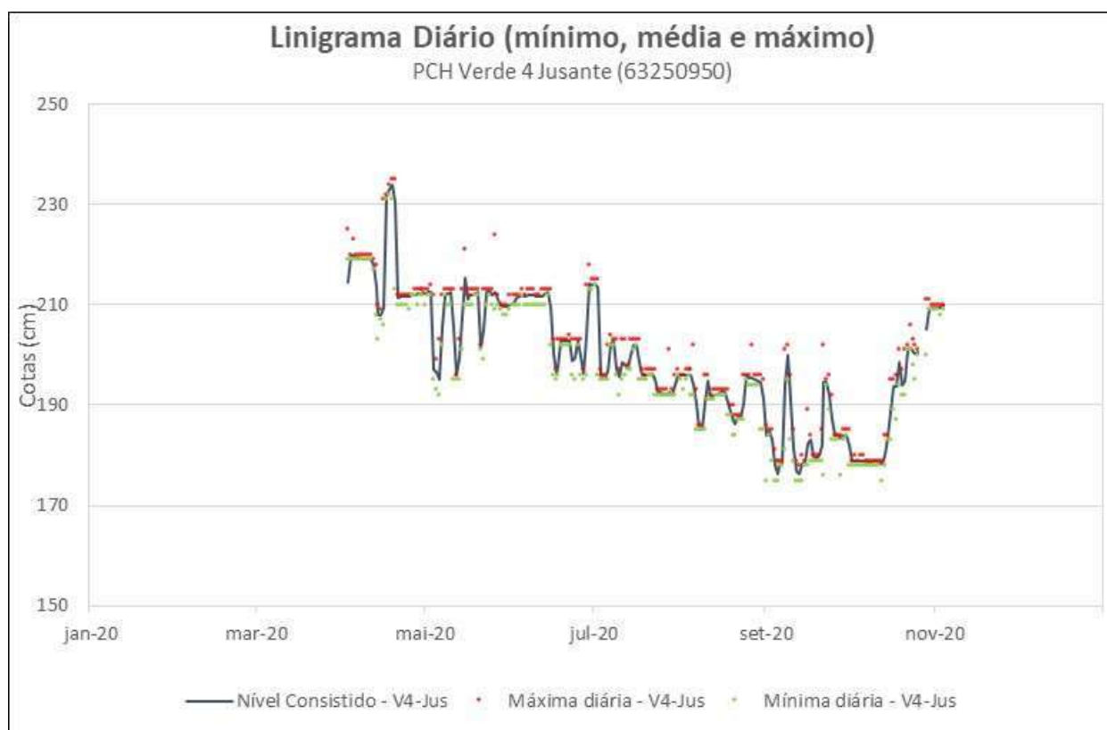
Figura 2.2 - Linigrama médio, mínimo e máximo diário da estação de Verde 4 Jusante em 2020.
